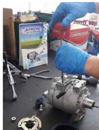
10_ RIEMPIRE IL COMPRESSORE DI OLIO
