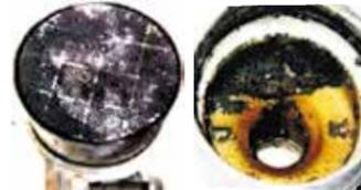
Corpo aperto di una pompa otturata da depositi e morchie di sedimenti.
