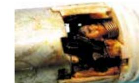
Danni da fusione in seguito a funzionamento a secco.
