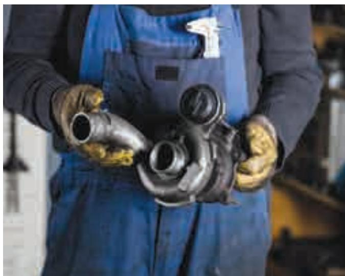
turbocompressori, sulle conseguenze che possono avere sull'intero motore.
