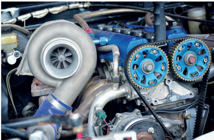
porre nelle officine è il lavaggio del sistema di lubrificazione del motore quando si sostituisce il turbocompressore.
